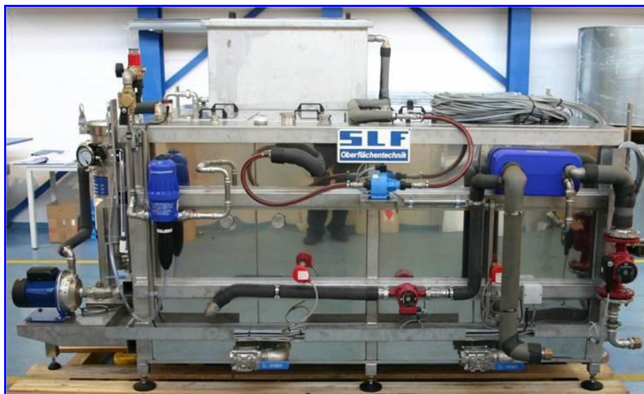
Anlagenbeispiel: Prozesswasserkreislaufanlage mit Badheizung über Warmwasser (PWW), Plattenphasentrenner (Ölabscheider)
